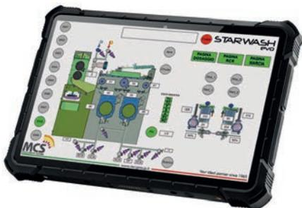
Tablet 10" Rugged IP67 Windows 10 IOT, sin instalar software adicional, permite la conexión al sistema para monitoreo/uso del sistema vía Wifi, simplifica enormemente todas las interacciones con la máquina (inicio/parada).
