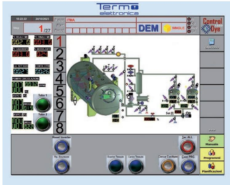
Painel de operador desenvolvido no windows para implementar de forma avançada todas as funções de diagnóstico, monitoramento e automação das máquinas de tingimento.
