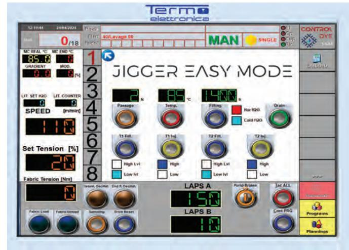
Pantalla toque 15" touch screen desenvolvido no windows para implementar de forma avançada todas as funções de diagnóstico, monitoramento e automação das máquinas de tingimento. A pedido, você pode usar qualquer micro disponível no mercado.
