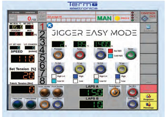
Pannello operatore touch screen da 15" sviluppato in ambiente windows per implementare in modo avanzato tutte le funzionalità diagnostiche, di monitoraggio e di automazione delle macchine di tintura. A richiesta è possibile l'impiego di qualsiasi micro disponibile sul mercato.
