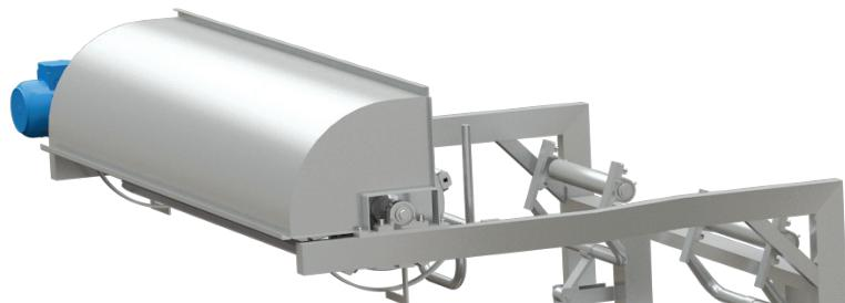
**Sistema di accesso** per ogni singolo corpo costituente la macchina, con ampio portello a manovra rapida ergonomico
