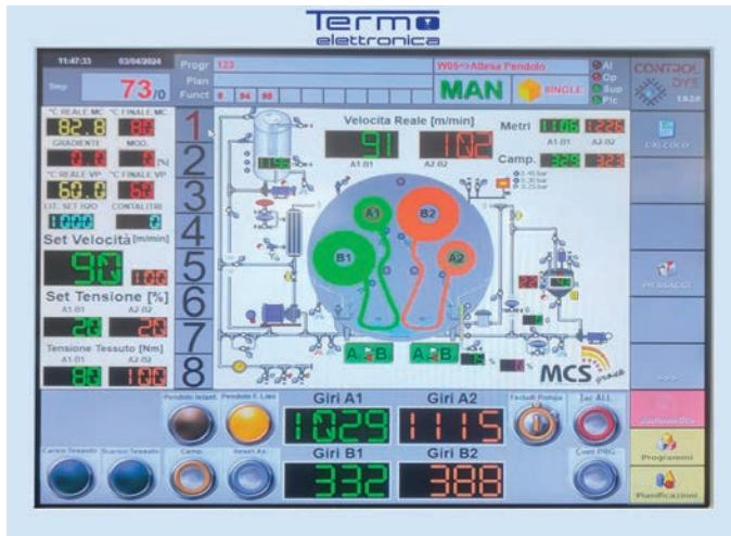
Pannello operatore touch screen da 15" sviluppato in ambiente windows per implementare in modo avanzato tutte le funzionalità diagnostiche, di monitoraggio e di automazione delle macchine di tintura. A richiesta è possibile l'impiego di qualsiasi micro disponibile sul mercato.
